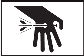
Nunca cierre la herramienta con la mano sobre el extremo de carga de esta herramienta de fijación. Esto puede ocasionar una lesión grave en la mano causada por la penetración del pistón o por el disparo de un elemento de fijación.
